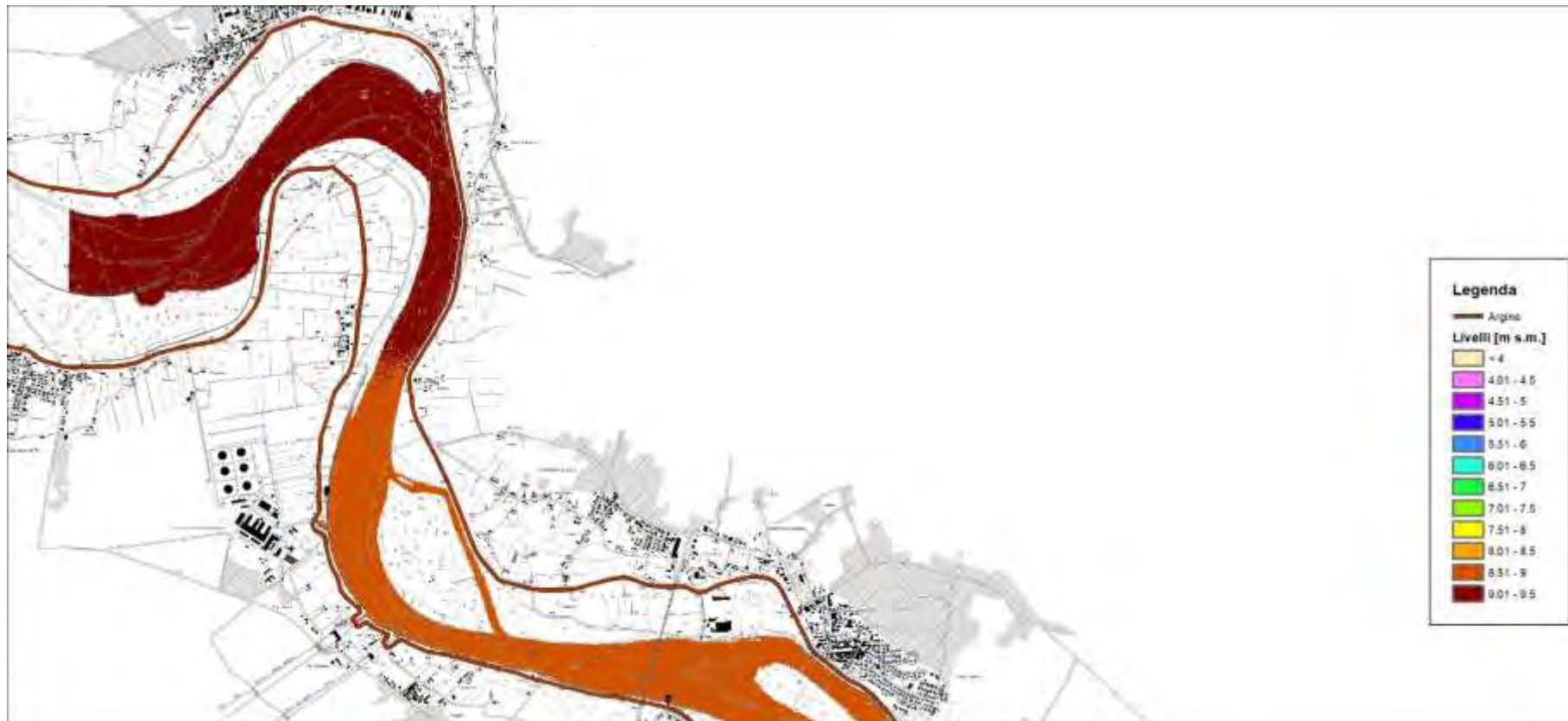
Figura 31 – risultati modello idraulico bidimensionale a fondo fisso – stato attuale – portata media annua – livelli idrici – 1 di 4 (scala 1:50'000)
