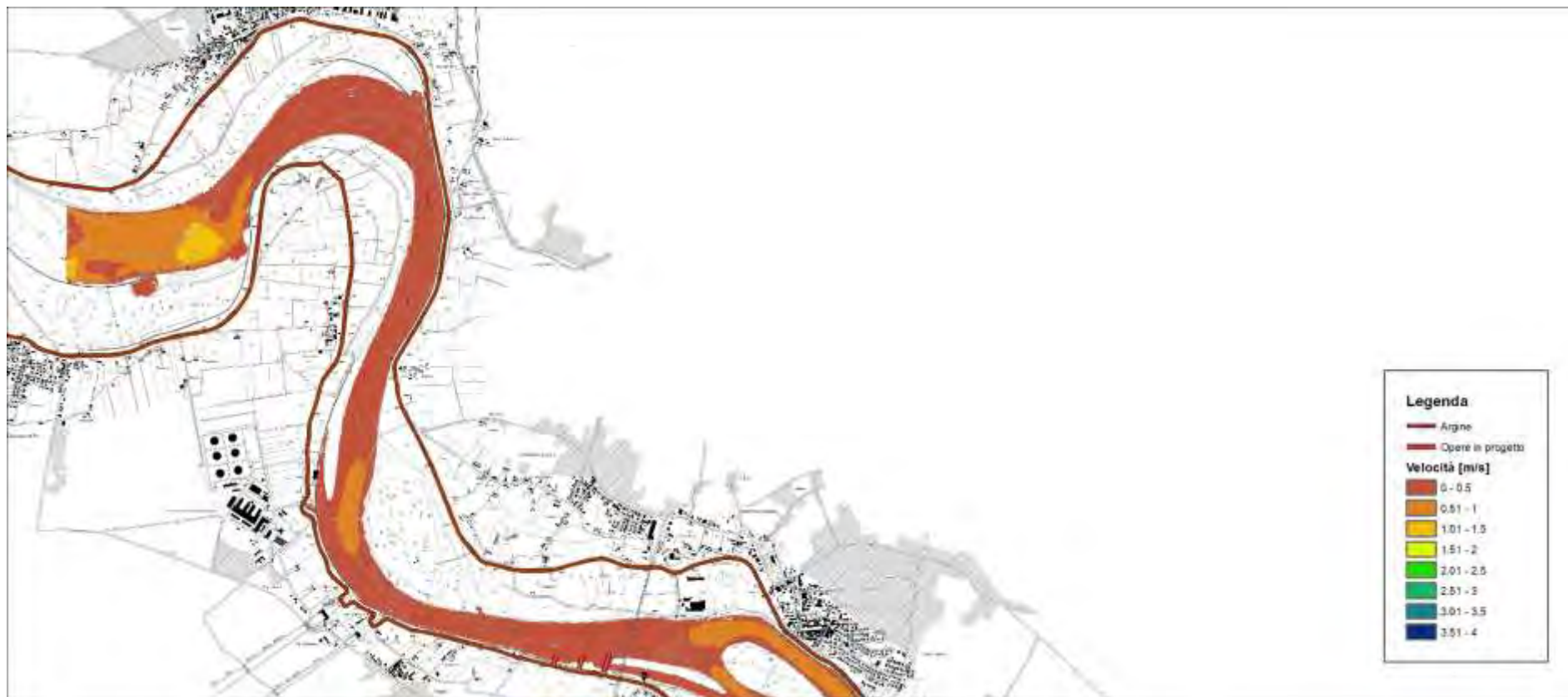
Figura 111 – risultati modello idraulico bidimensionale a fondo fisso – assetto di progetto – portata magra – velocità della corrente – 1 di 4 (scala 1:50'000)
