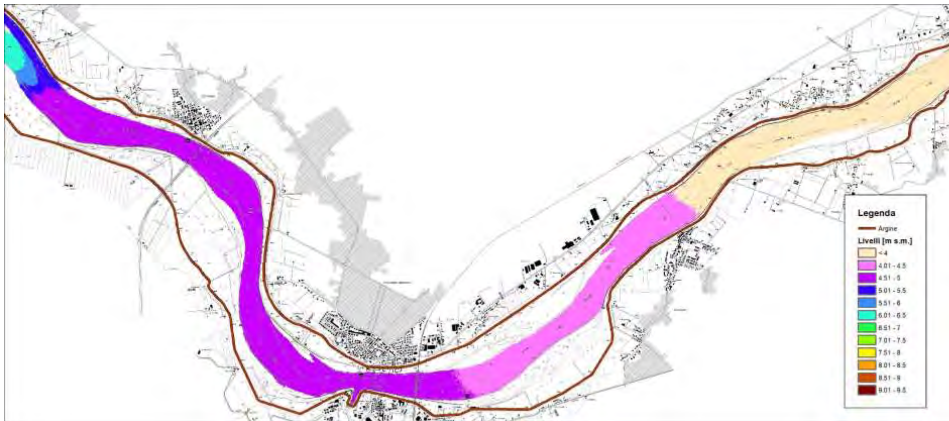
Figura 34 – risultati modello idraulico bidimensionale a fondo fisso – stato attuale – portata media annua – livelli idrici – 4 di 4 (scala 1:50'000)
