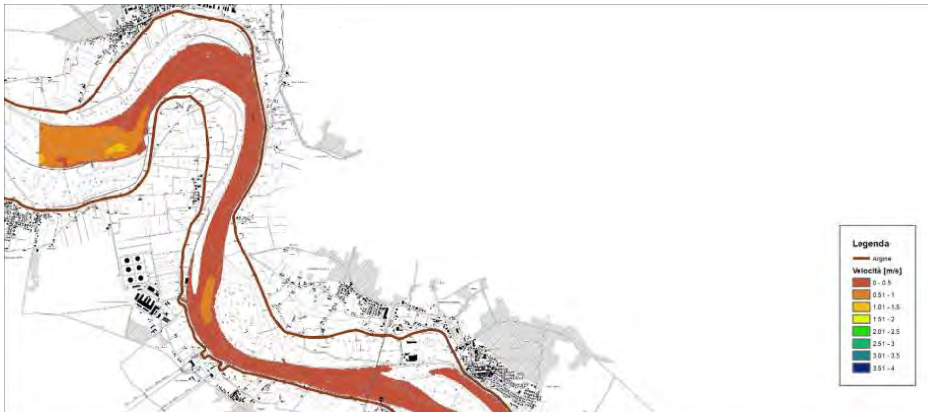
Figura 51 – risultati modello idraulico bidimensionale a fondo fisso – stato attuale – portata magra – velocità della corrente – 1 di 4 (scala 1:50'000)
