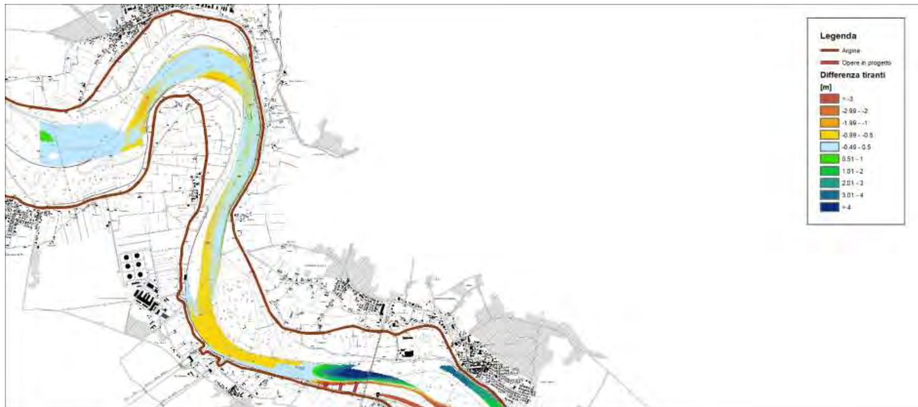
Figura 179 – risultati modello idraulico bidimensionale a fondo fisso – differenza tra assetto di progetto e stato attuale – portata in secca – tirante idrico – 1 di 4 (scala 1:50'000)
