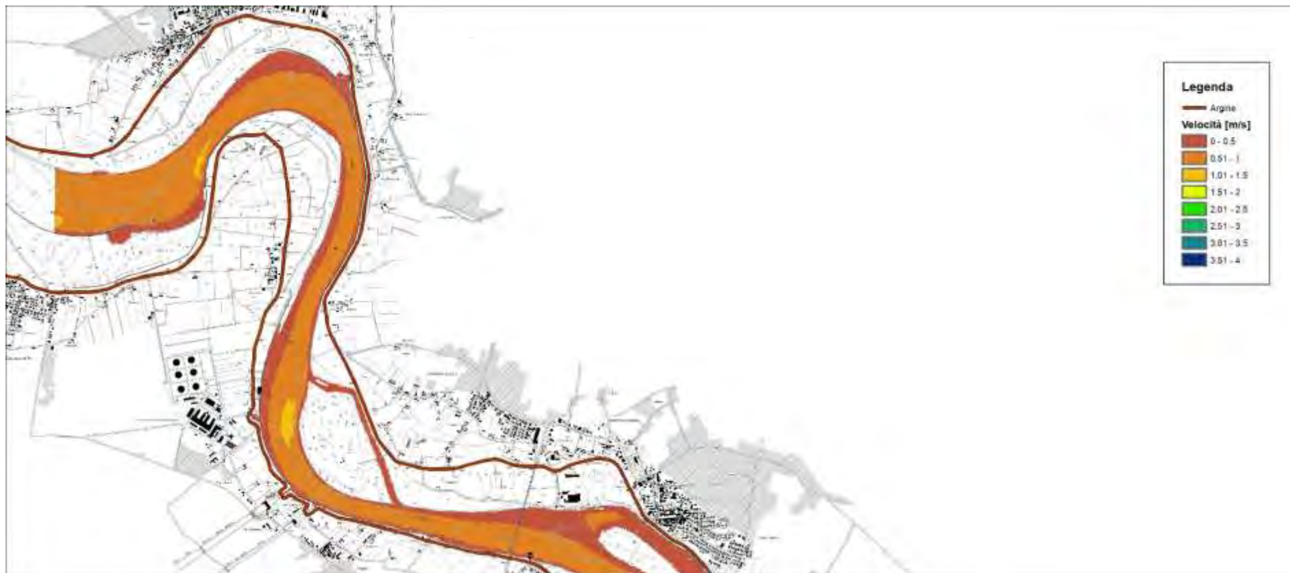
Figura 39 – risultati modello idraulico bidimensionale a fondo fisso – stato attuale – portata media annua – velocità della corrente – 1 di 4 (scala 1:50'000)
