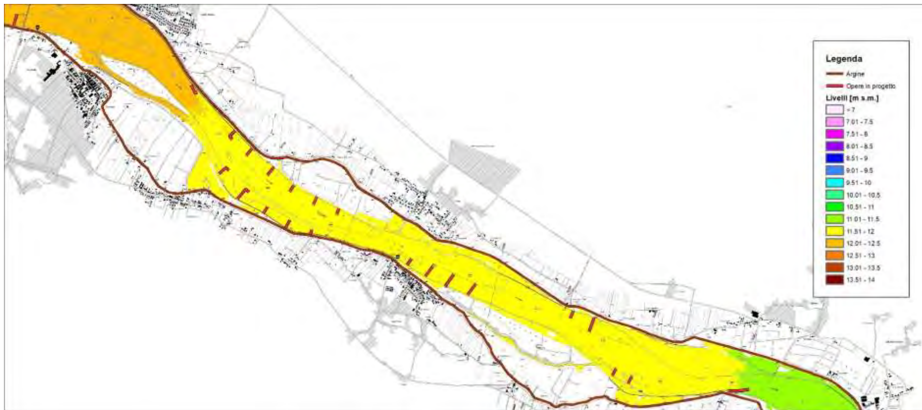
Figura 80 – risultati modello idraulico bidimensionale a fondo fisso – assetto progetto – piena ordinaria – livelli idrici – 2 di 4 (scala 1:50'000)
