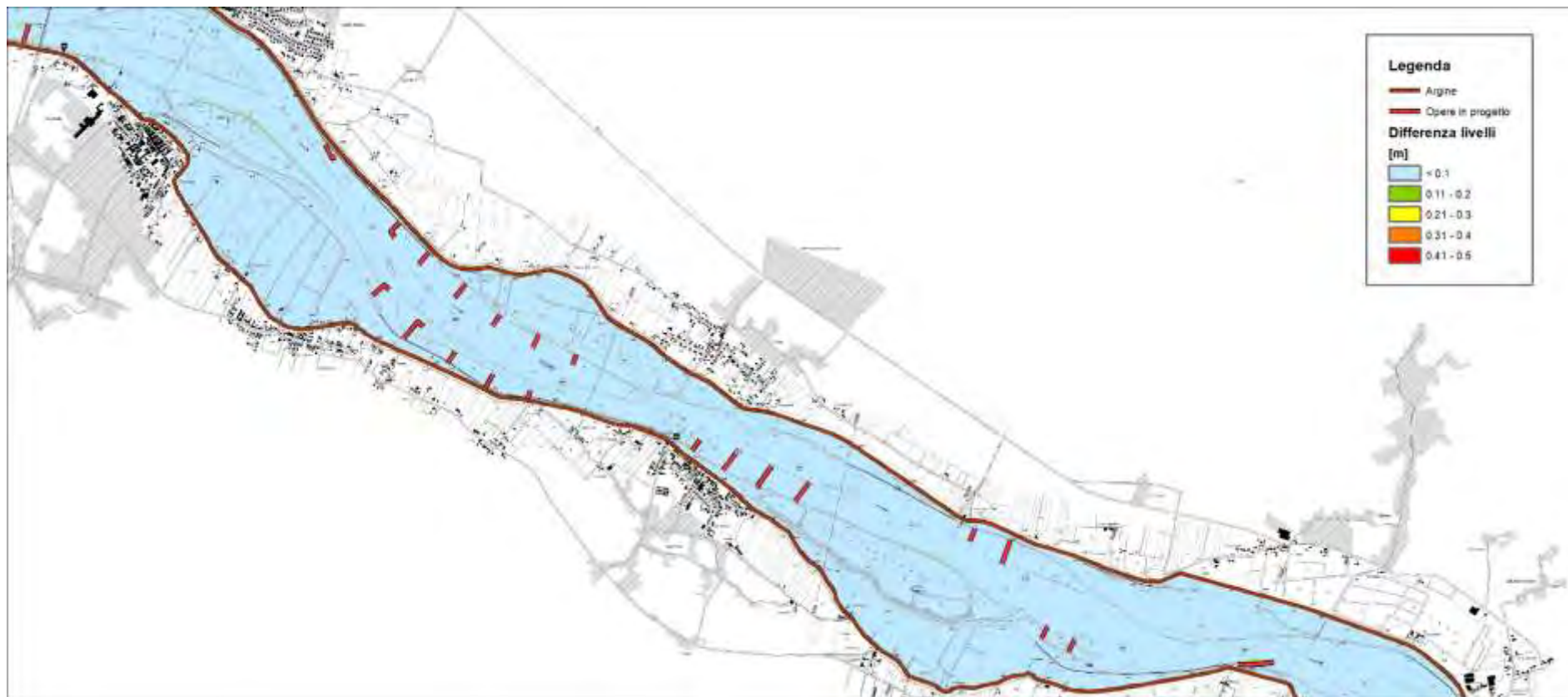
Figura 128 – risultati modello idraulico bidimensionale a fondo fisso – differenza tra assetto di progetto e stato attuale – piena PAI – livelli idrici – 2 di 4 (scala 1:50'000)
