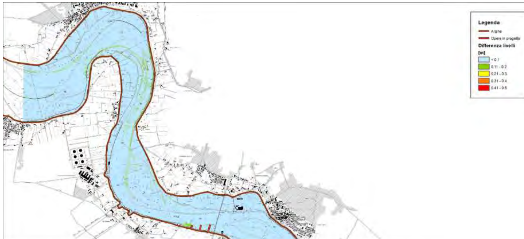
Figura 127 – risultati modello idraulico bidimensionale a fondo fisso – differenza tra assetto di progetto e stato attuale – piena PAI – livelli idrici – 1 di 4 (scala 1:50'000)
