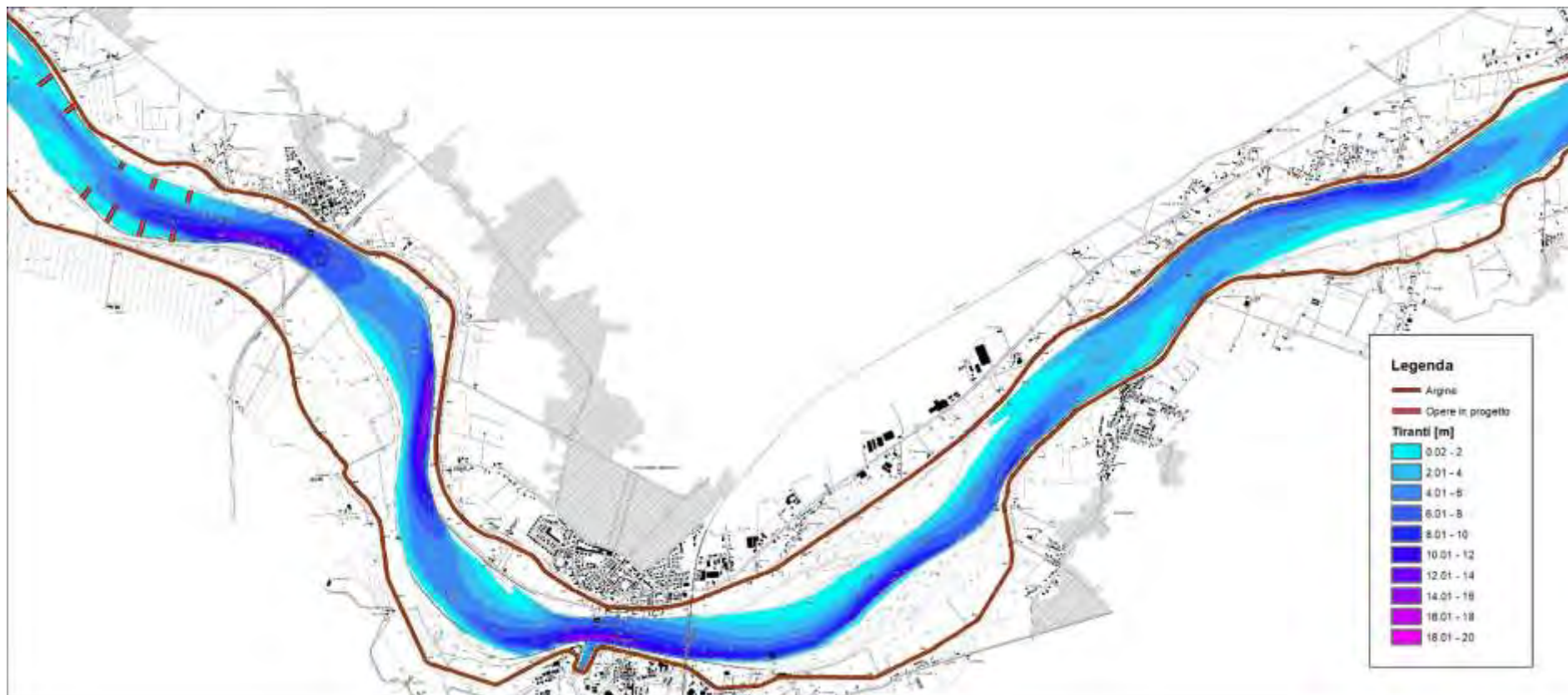
Figura 98 – risultati modello idraulico bidimensionale a fondo fisso – assetto progetto – portata media annua – tiranti idrici – 4 di 4 (scala 1:50'000)
