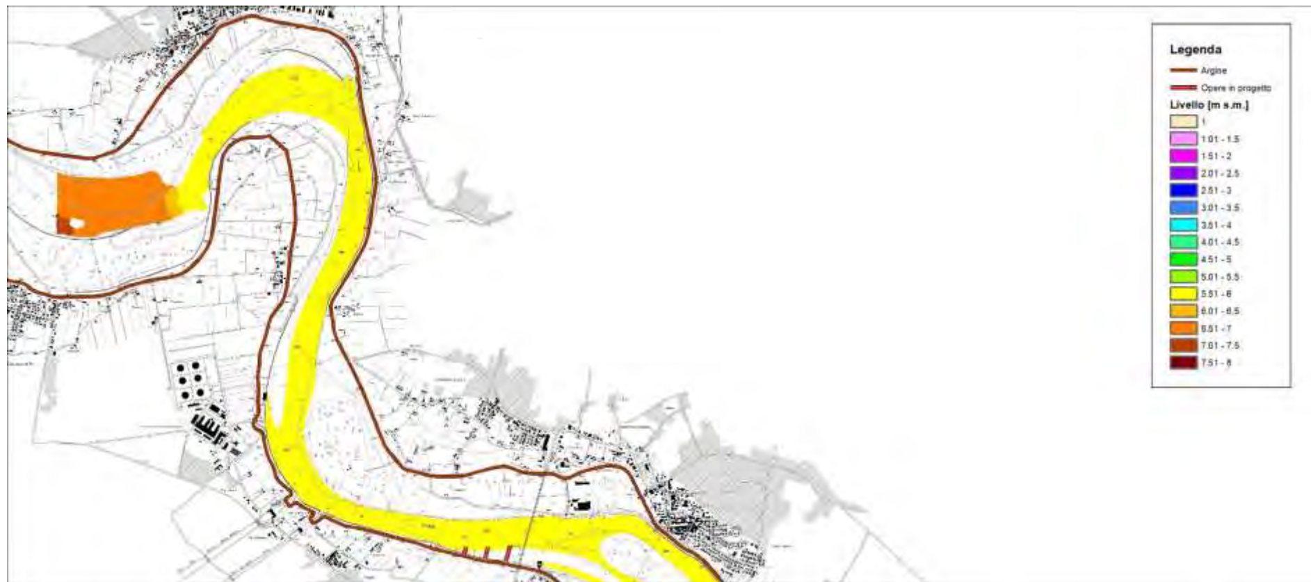
Figura 115 – risultati modello idraulico bidimensionale a fondo fisso – assetto di progetto – portata in secca – livello idrico – 1 di 4 (scala 1:50'000)
