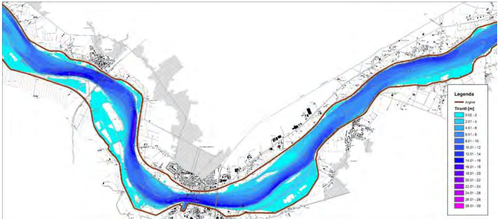
Figura 26 – risultati modello idraulico bidimensionale a fondo fisso – stato attuale – piena ordinaria – tiranti idrici – 4 di 4 (scala 1:50'000)
