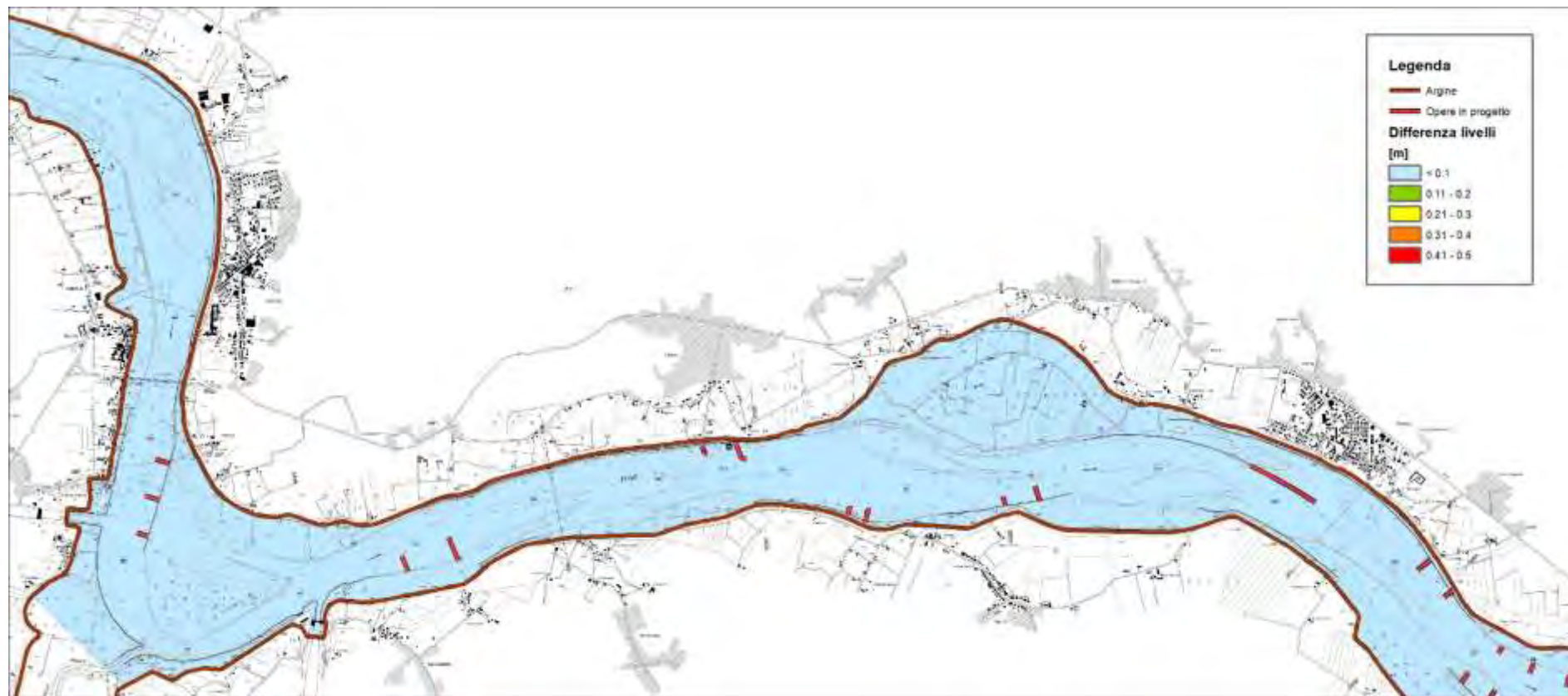
Figura 129 – risultati modello idraulico bidimensionale a fondo fisso – differenza tra assetto di progetto e stato attuale – piena PAI – livelli idrici – 3 di 4 (scala 1:50'000)
