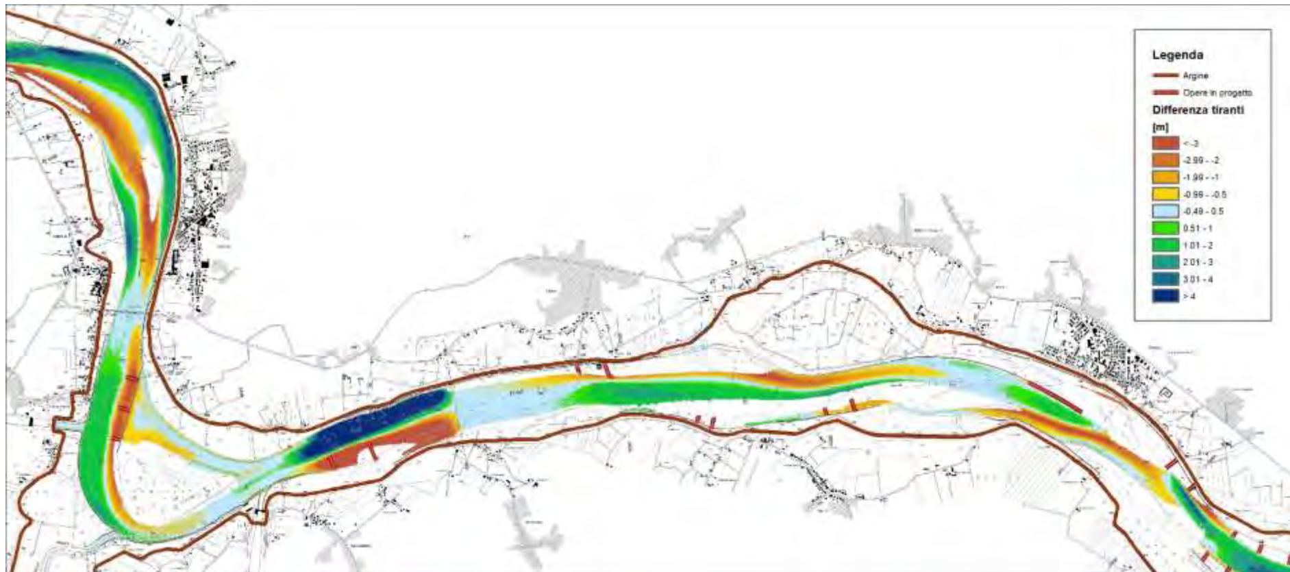
Figura 169 – risultati modello idraulico bidimensionale a fondo fisso – differenza tra assetto di progetto e stato attuale – portata magra – tirante idrico – 3 di 4 (scala 1:50'000)
