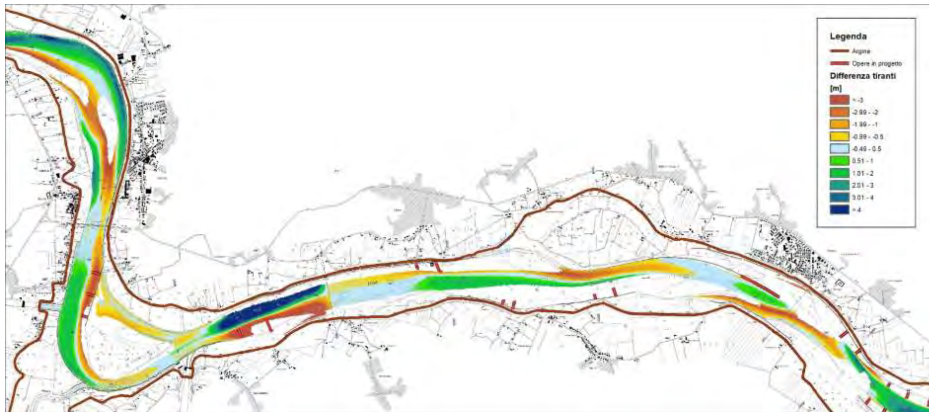
Figura 181 – risultati modello idraulico bidimensionale a fondo fisso – differenza tra assetto di progetto e stato attuale – portata in secca – tirante idrico – 3 di 4 (scala 1:50'000)
