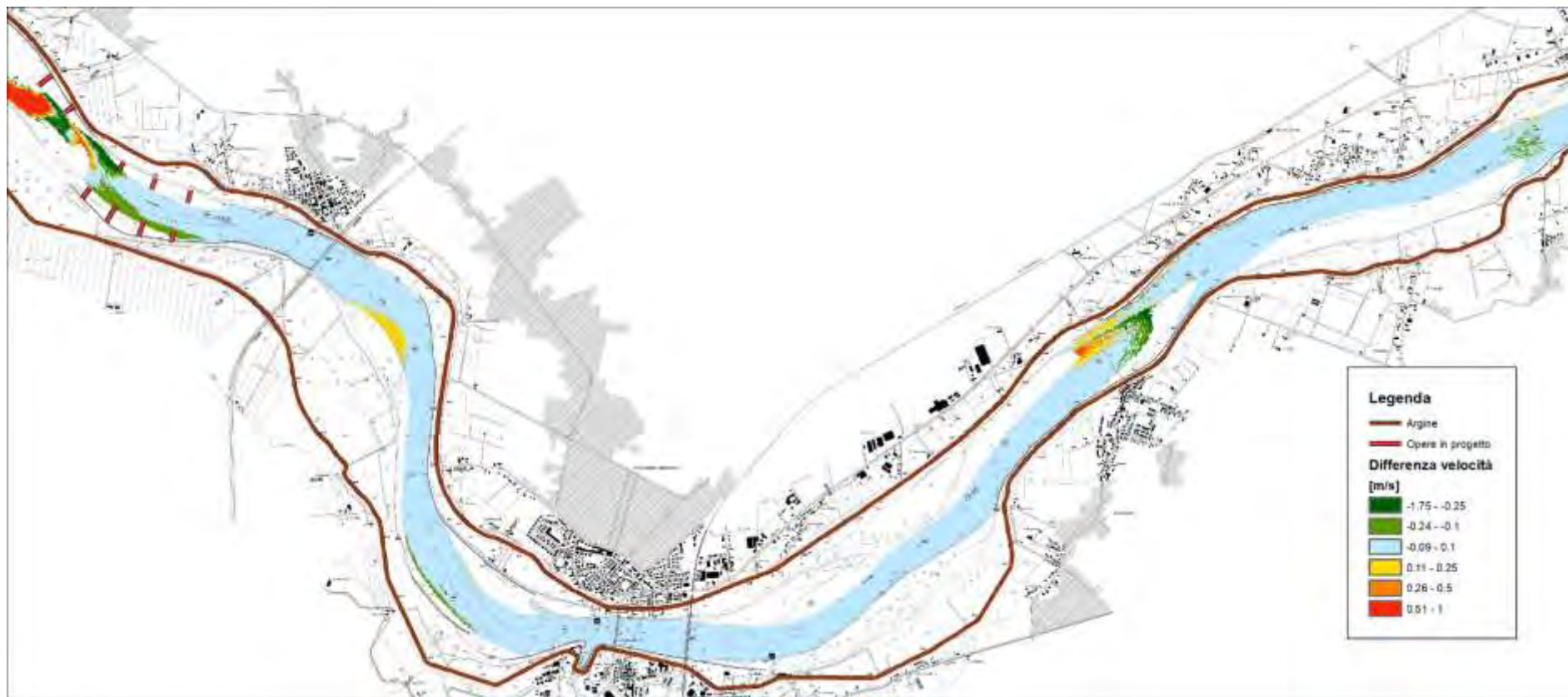
Figura 186 – risultati modello idraulico bidimensionale a fondo fisso – differenza tra assetto di progetto e stato attuale – portata in secca – velocità della corrente – 4 di 4 (scala 1:50'000)
