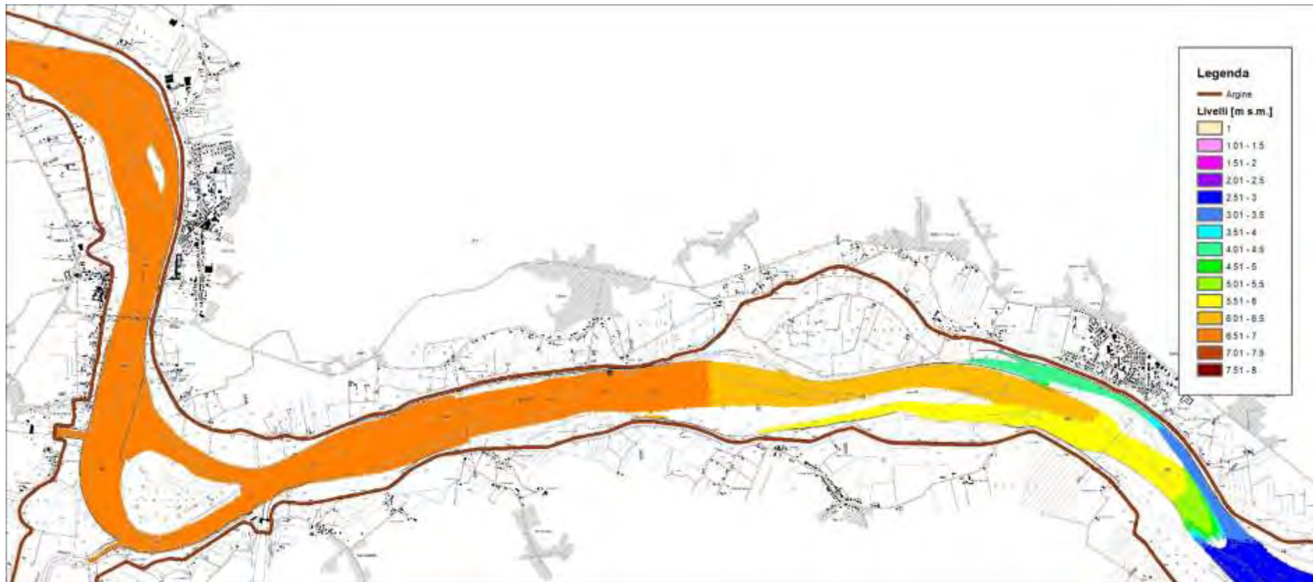
Figura 45 – risultati modello idraulico bidimensionale a fondo fisso – stato attuale – portata magra – livello idrico – 3 di 4 (scala 1:50'000)
