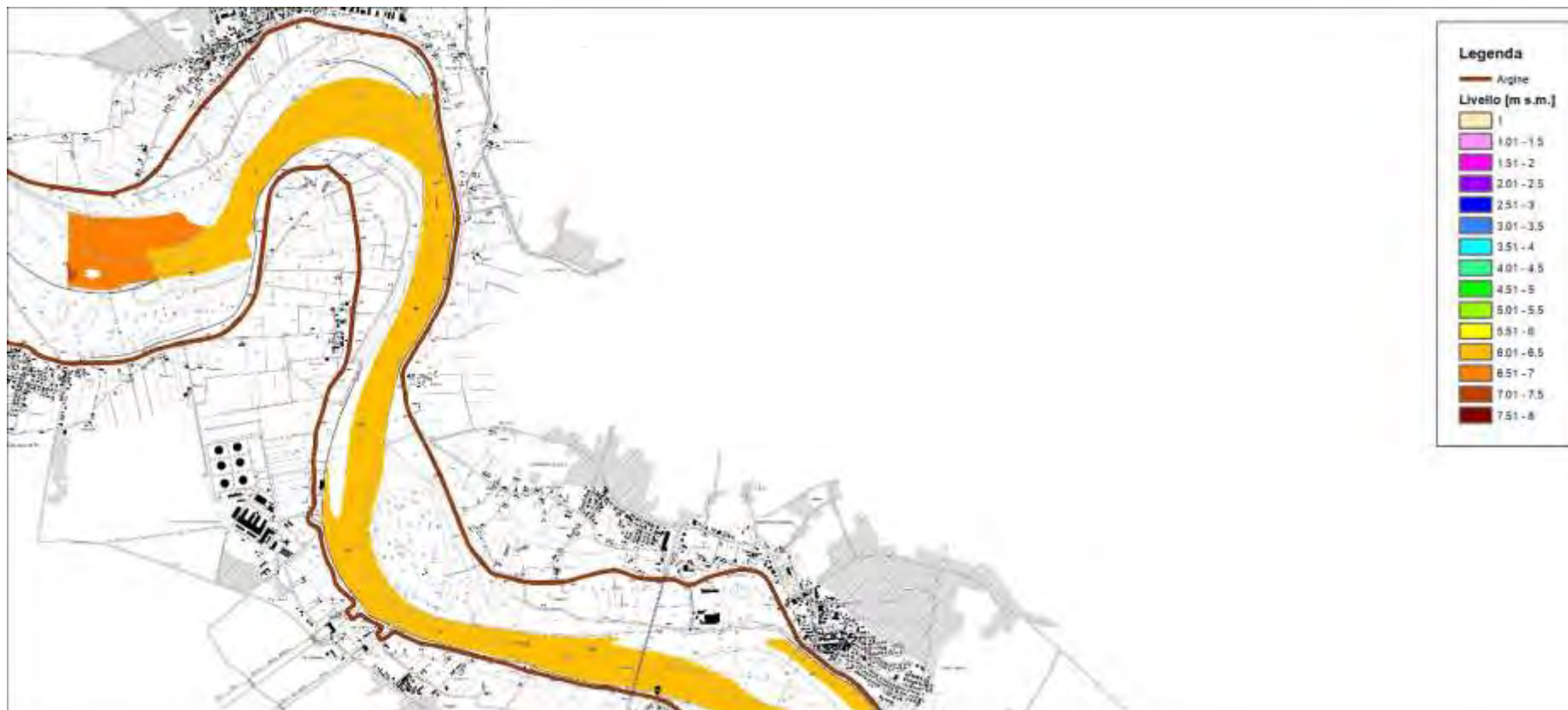
Figura 55 – risultati modello idraulico bidimensionale a fondo fisso – stato attuale – portata in secca – livello idrico – 1 di 4 (scala 1:50'000)
