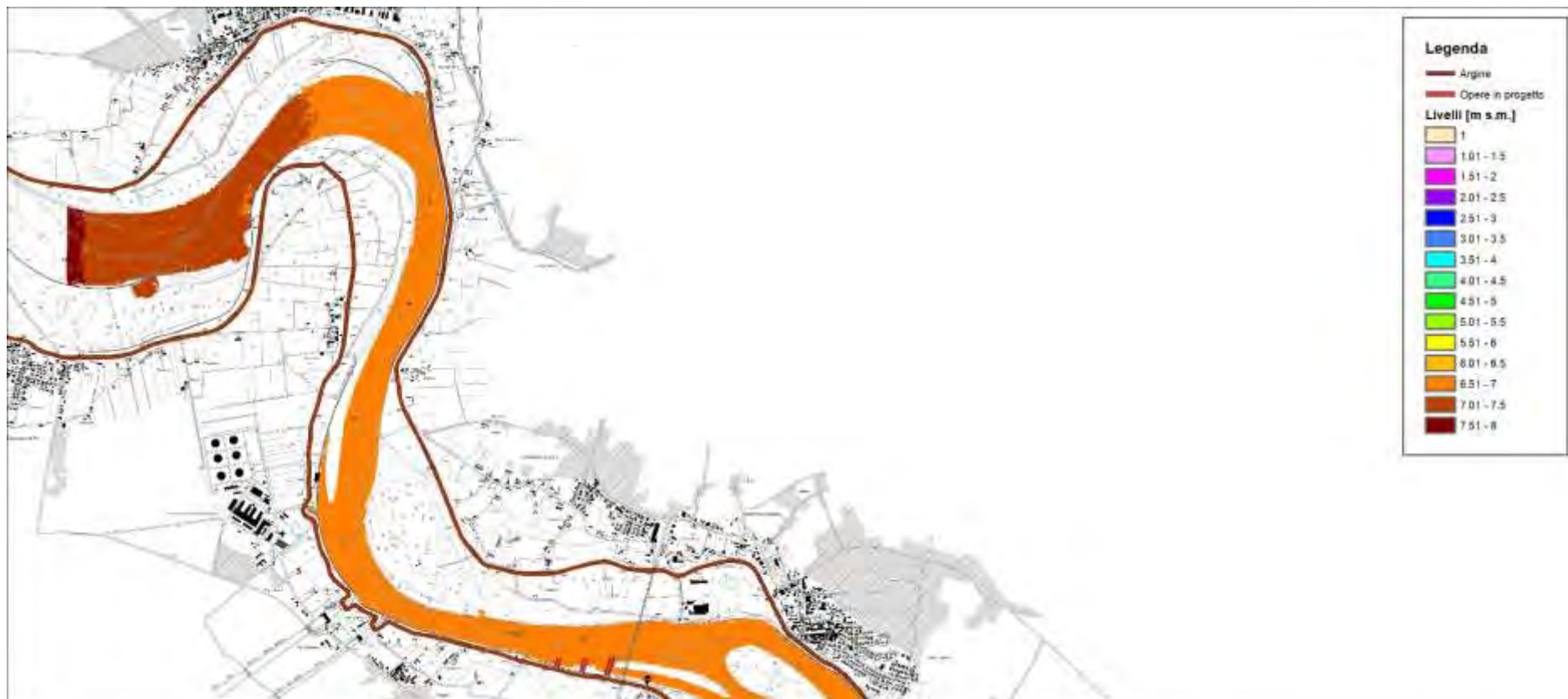
Figura 103 – risultati modello idraulico bidimensionale a fondo fisso – assetto di progetto – portata magra – livello idrico – 1 di 4 (scala 1:50'000)
