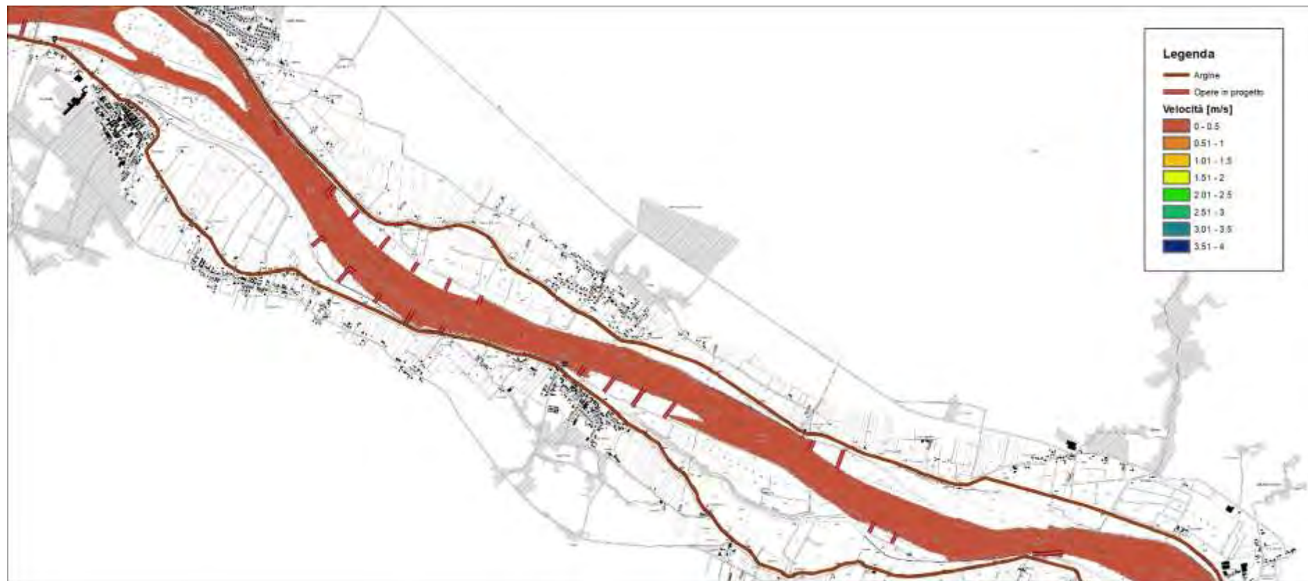
Figura 124 – risultati modello idraulico bidimensionale a fondo fisso – assetto di progetto – portata in secca – velocità della corrente – 2 di 4 (scala 1:50'000)
