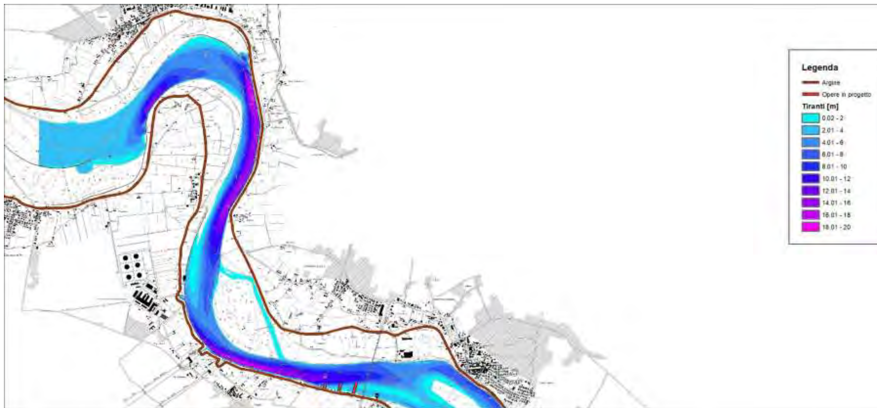
Figura 95 – risultati modello idraulico bidimensionale a fondo fisso – assetto progetto – portata media annua – tiranti idrici – 1 di 4 (scala 1:50'000)
