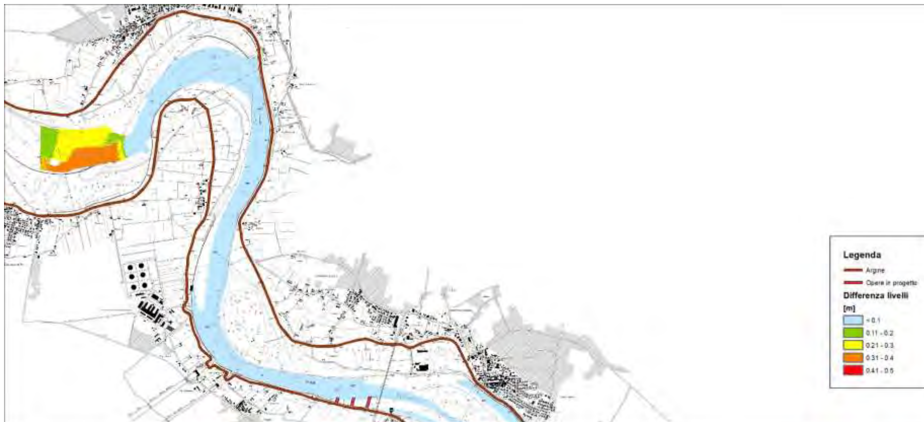
Figura 175 – risultati modello idraulico bidimensionale a fondo fisso – differenza tra assetto di progetto e stato attuale – portata in secca – livello idrico – 1 di 4 (scala 1:50'000)
