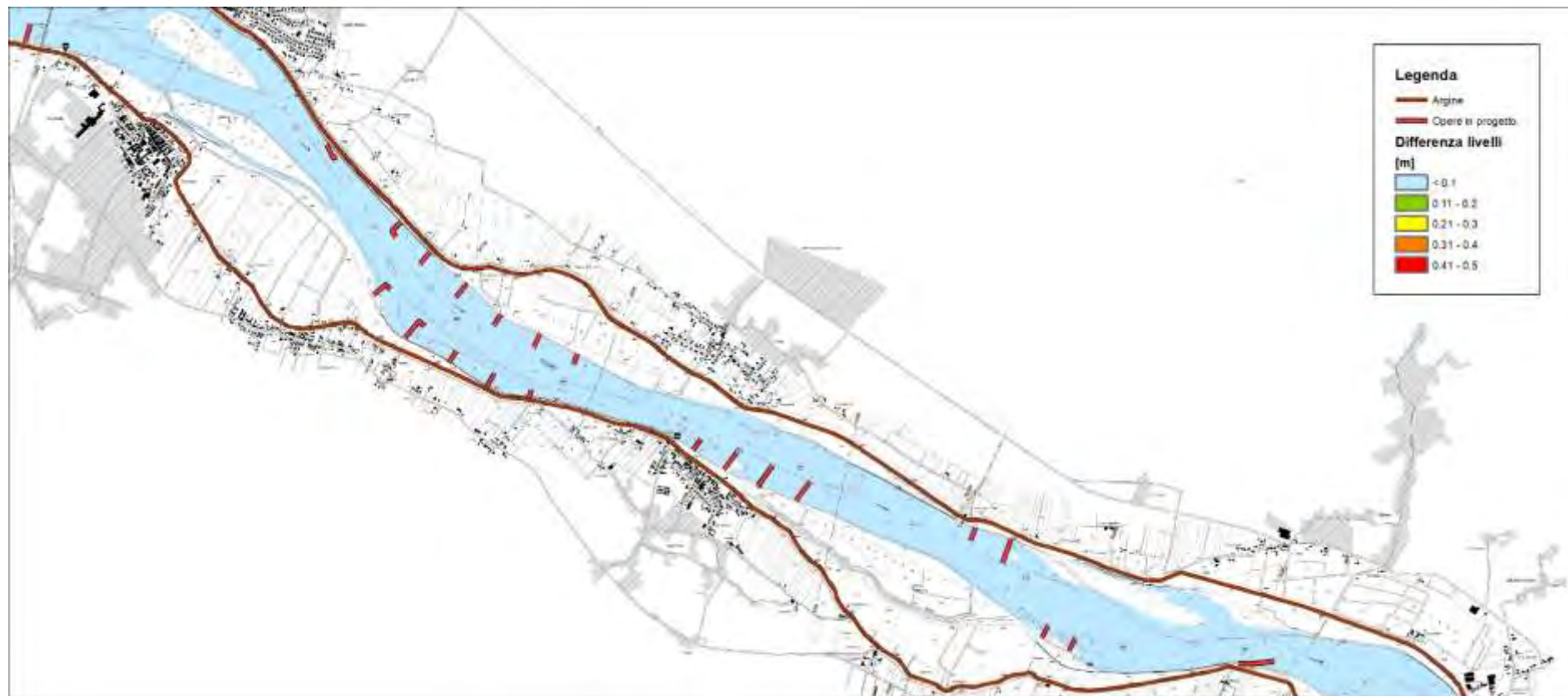
Figura 152 – risultati modello idraulico bidimensionale a fondo fisso – differenza tra assetto di progetto e stato attuale – portata media – livello idrico – 2 di 4 (scala 1:50'000)
