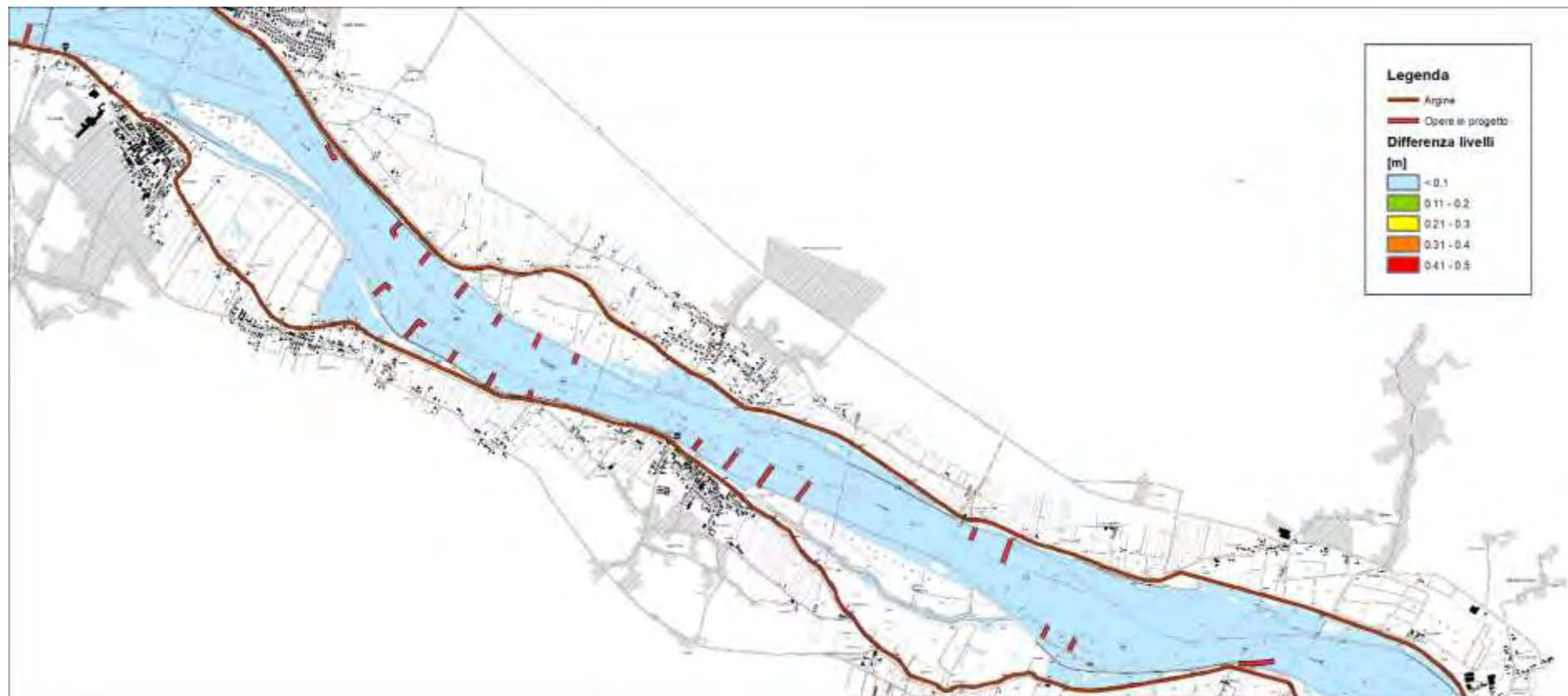
Figura 140 – risultati modello idraulico bidimensionale a fondo fisso – differenza tra assetto di progetto e stato attuale – piena ordinaria – livello idrico – 2 di 4 (scala 1:50'000)
