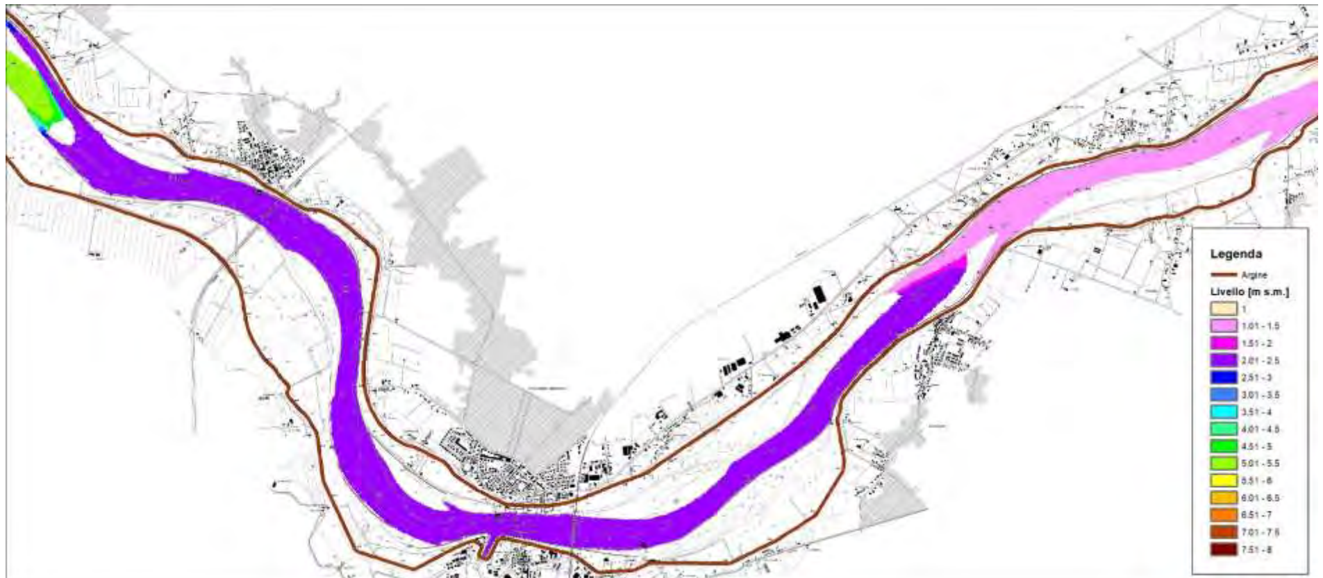
Figura 58 – risultati modello idraulico bidimensionale a fondo fisso – stato attuale – portata in secca – livello idrico – 4 di 4 (scala 1:50'000)
