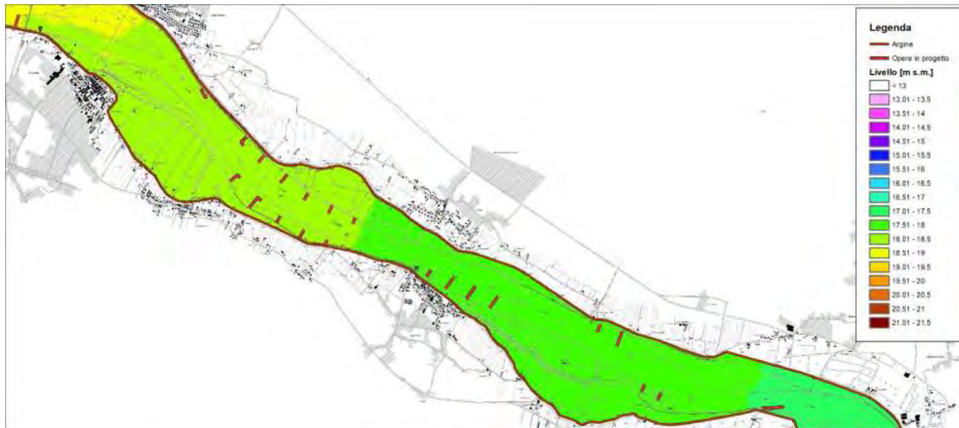
Figura 68 – risultati modello idraulico bidimensionale a fondo fisso – assetto progetto – piena PAI – livelli idrici – 2 di 4 (scala 1:50'000)
