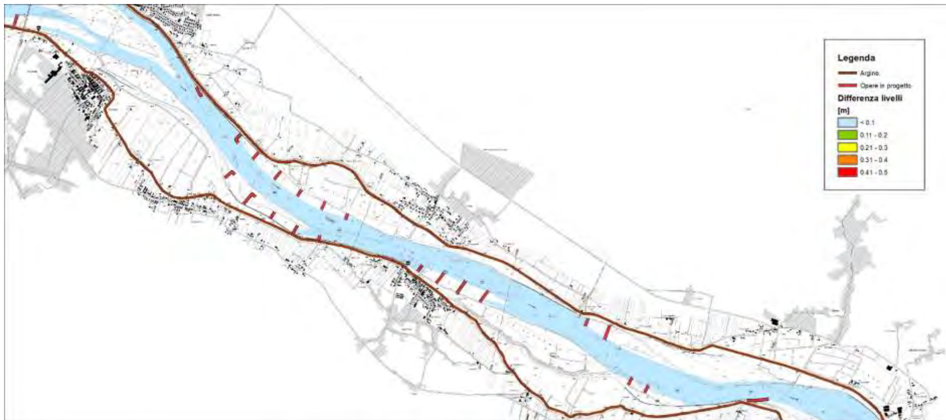
Figura 176 – risultati modello idraulico bidimensionale a fondo fisso – differenza tra assetto di progetto e stato attuale – portata in secca – livello idrico – 2 di 4 (scala 1:50'000)
