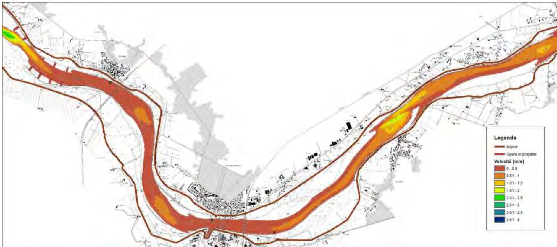
Figura 114 – risultati modello idraulico bidimensionale a fondo fisso – assetto di progetto – portata magra – velocità della corrente – 4 di 4 (scala 1:50'000)
