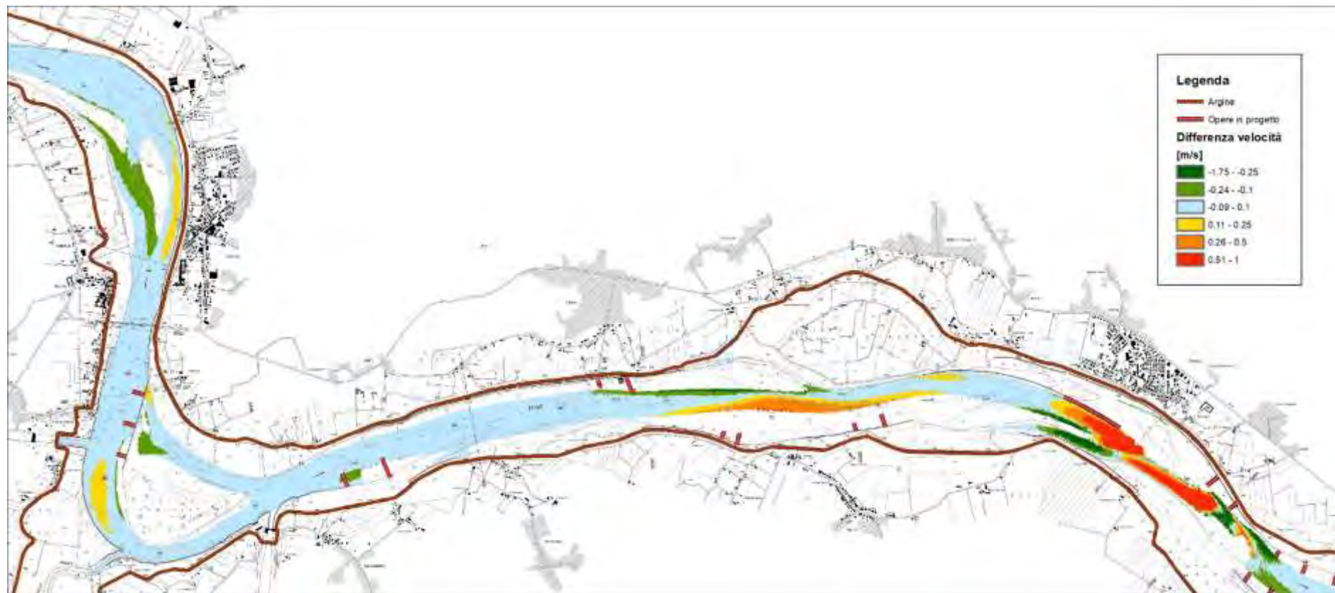
Figura 185 – risultati modello idraulico bidimensionale a fondo fisso – differenza tra assetto di progetto e stato attuale – portata in secca – velocità della corrente – 3 di 4 (scala 1:50'000)
