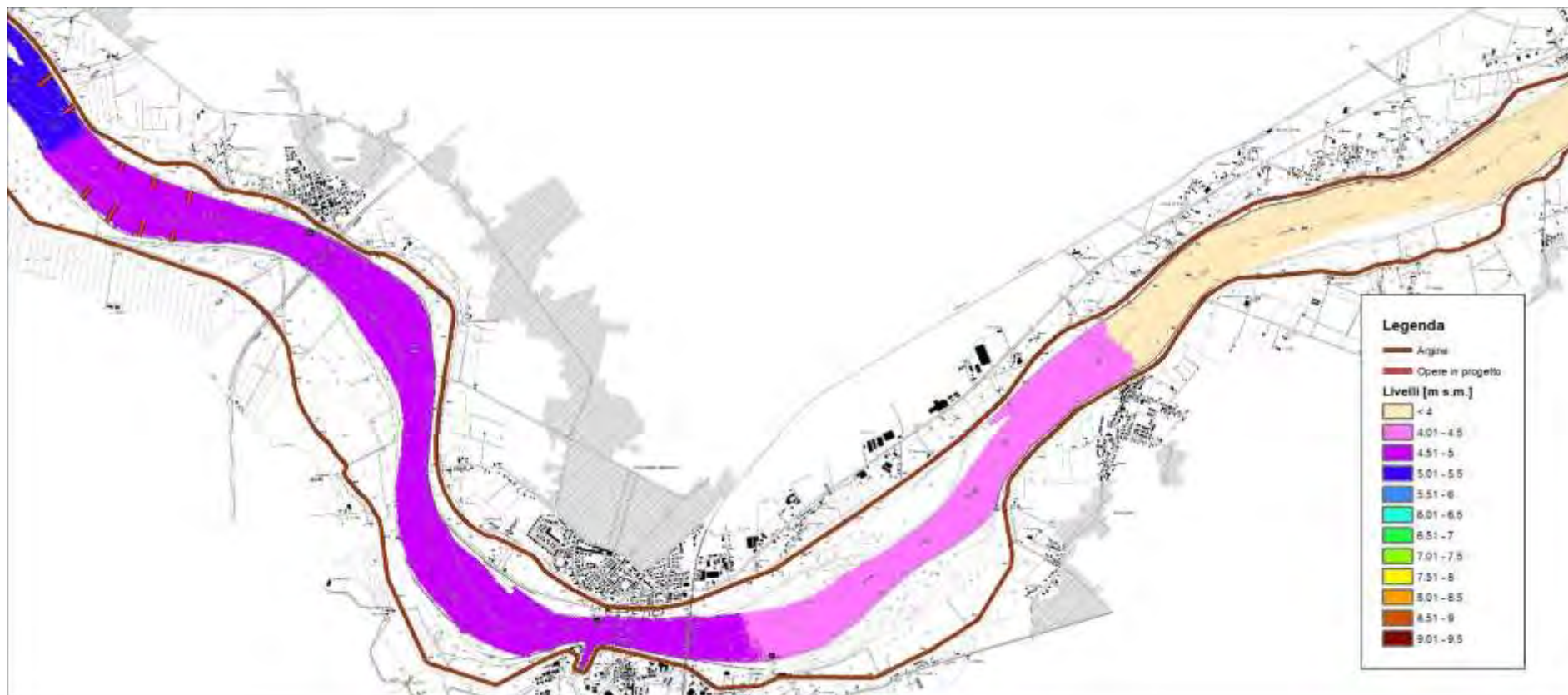
Figura 94 – risultati modello idraulico bidimensionale a fondo fisso – assetto progetto – portata media annua – livelli idrici – 4 di 4 (scala 1:50'000)
