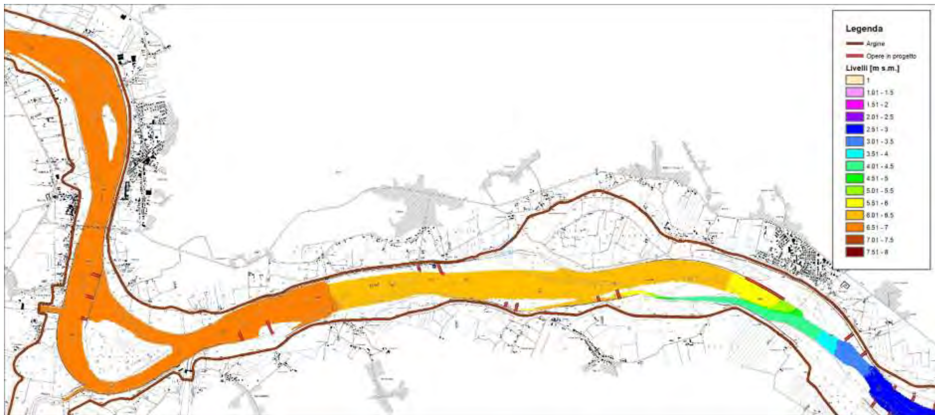
Figura 105 – risultati modello idraulico bidimensionale a fondo fisso – assetto di progetto – portata magra – livello idrico – 3 di 4 (scala 1:50'000)
