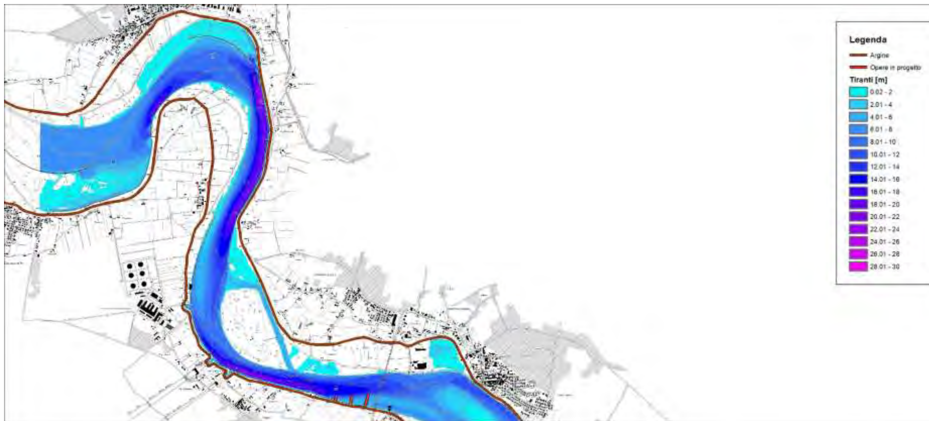
Figura 83 – risultati modello idraulico bidimensionale a fondo fisso – assetto progetto – piena ordinaria – tiranti idrici – 1 di 4 (scala 1:50'000)
