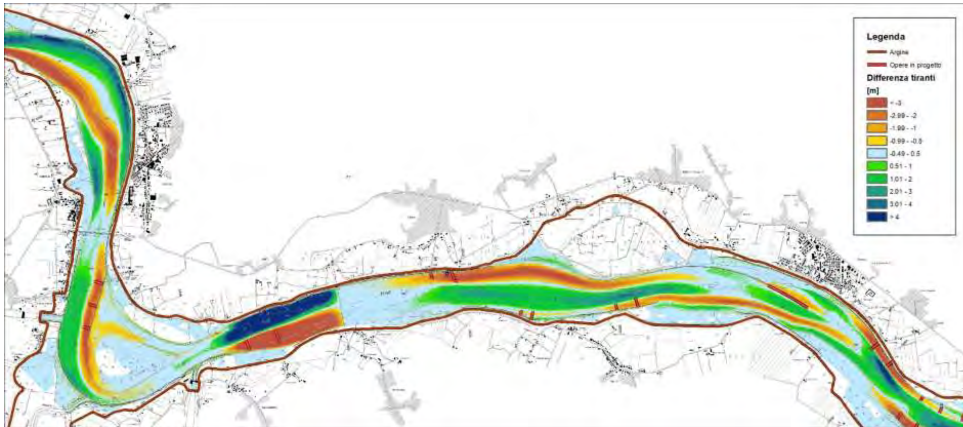
Figura 145 – risultati modello idraulico bidimensionale a fondo fisso – differenza tra assetto di progetto e stato attuale – piena ordinaria – tirante idrico – 3 di 4 (scala 1:50'000)
