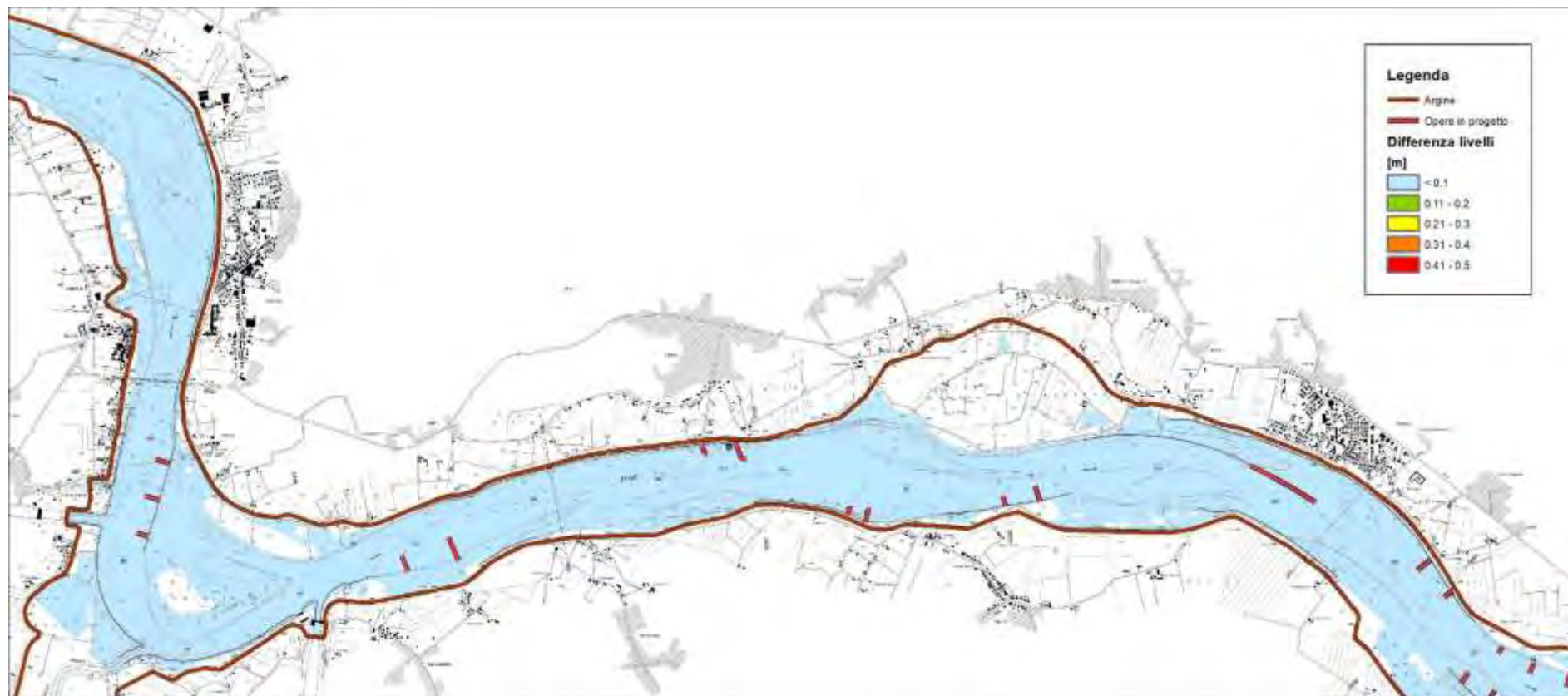
Figura 141 – risultati modello idraulico bidimensionale a fondo fisso – differenza tra assetto di progetto e stato attuale – piena ordinaria – livello idrico – 3 di 4 (scala 1:50'000)
