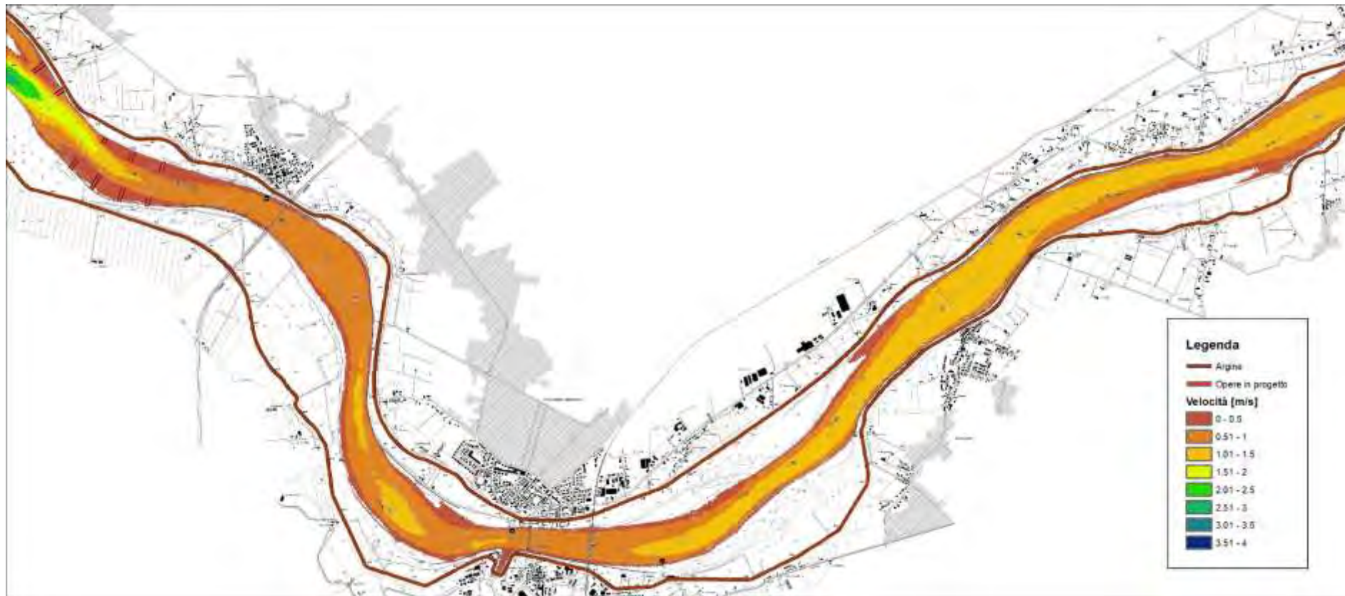
Figura 102 – risultati modello idraulico bidimensionale a fondo fisso – assetto progetto – portata media annua – velocità della corrente – 4 di 4 (scala 1:50'000)
