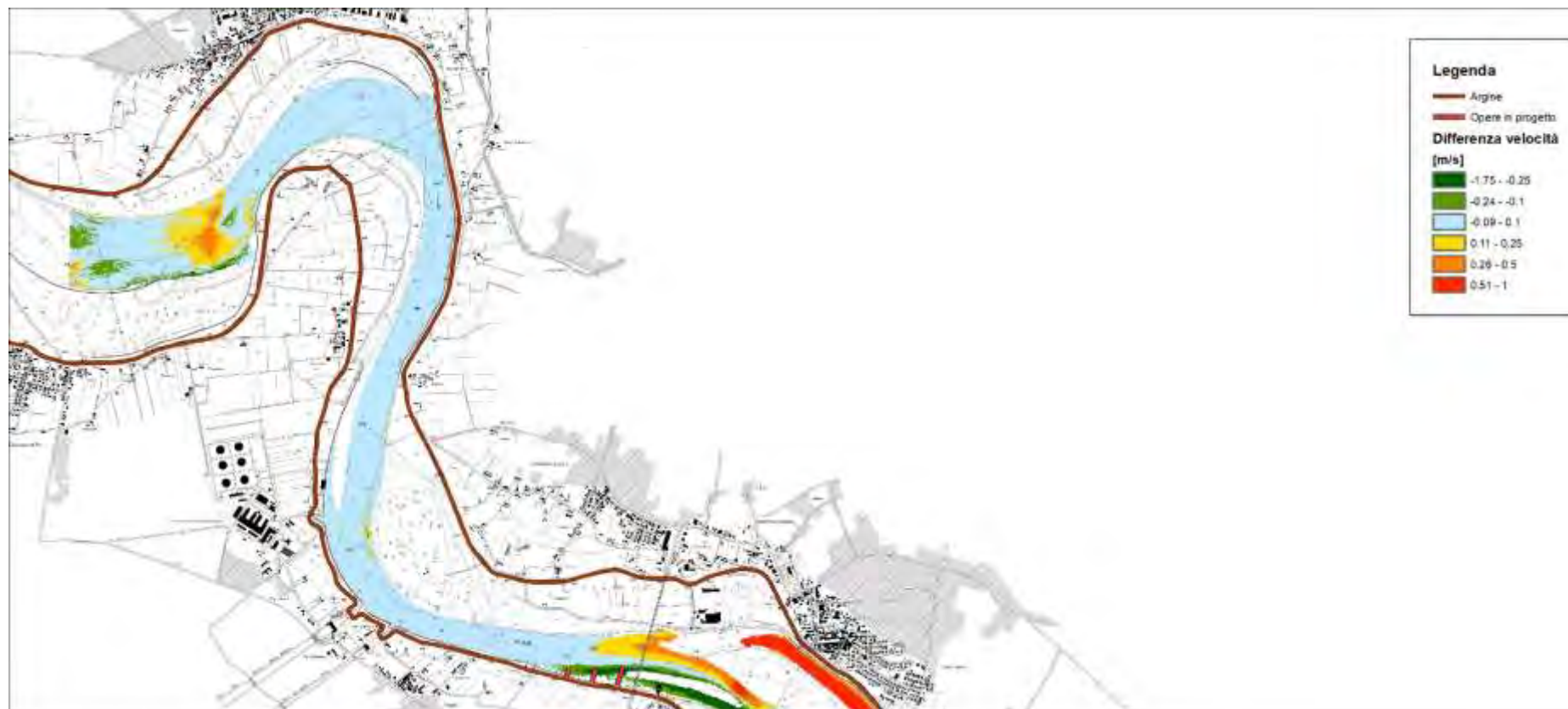
Figura 171 – risultati modello idraulico bidimensionale a fondo fisso – differenza tra assetto di progetto e stato attuale – portata magra – velocità della corrente – 1 di 4 (scala 1:50'000)
