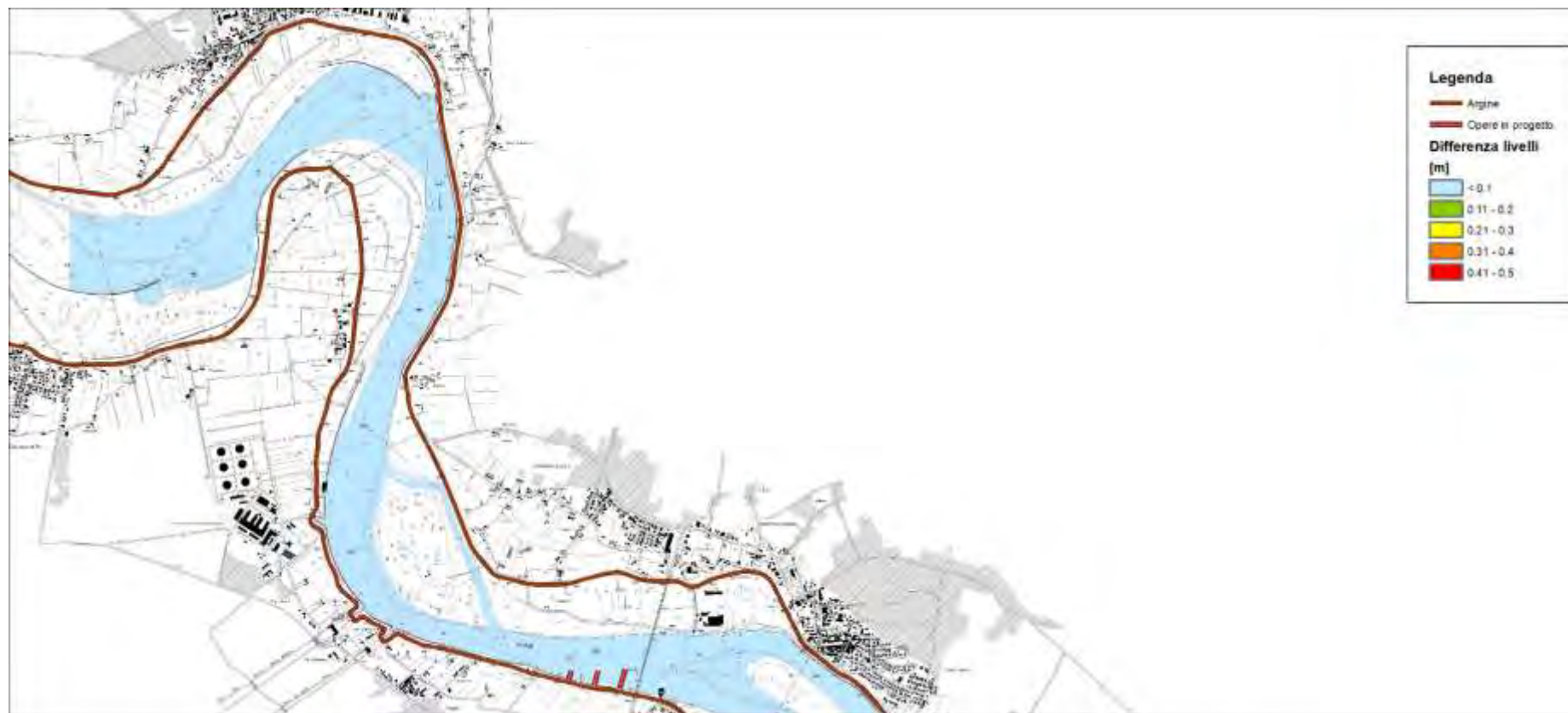
Figura 151 – risultati modello idraulico bidimensionale a fondo fisso – differenza tra assetto di progetto e stato attuale – portata media – livello idrico – 1 di 4 (scala 1:50'000)
